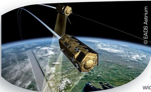
Mitte Juni ist der Radarsatellit TanDEM-X von Baikonur in Kasachstan in seine Umlaufbahn in 514 Kilometern Höhe gestartet. Gemeinsam mit dem 2007 gestarteten Satelliten TerraSAR-X, wird TanDEM-X für die Vermessung der Landoberfläche zuständig sein und so den Nutzern die Datengrundlage für ein globales Höhenmodell liefern. Eine wichtige Komponente des Satelliten kommt aus Sachsen. Der gesamte Kabelbaum (Harness) stammt aus dem Altran Entwicklungszentrum in Chemnitz. Innerhalb von zwei Jahren
